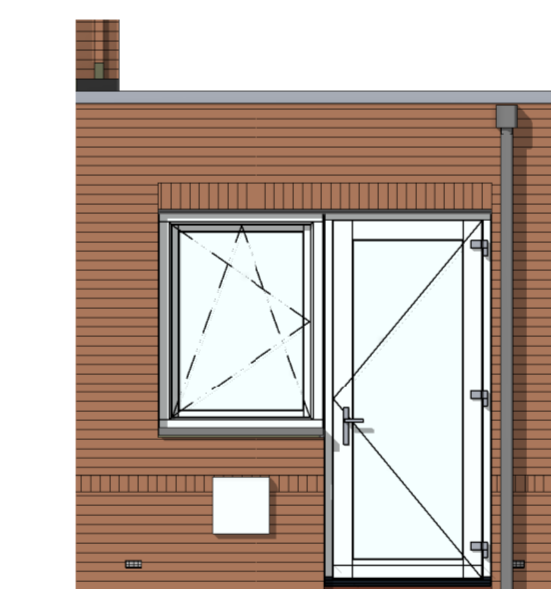
AG5022 - Enkele loopdeur en raam met gemetselde borstwering in achtergevel aanbouw
