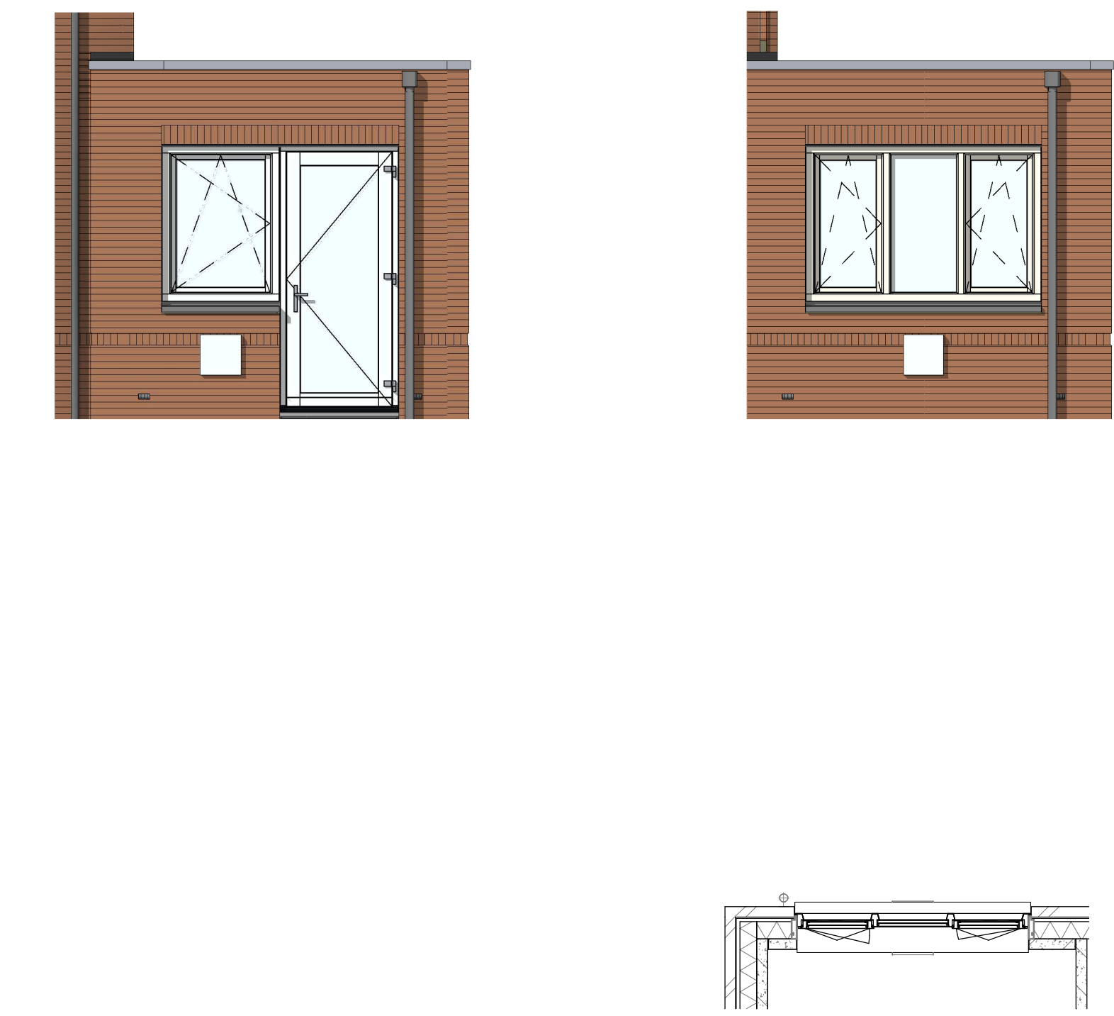
AG5022 - Enkele loopdeur en raam met gemetselde borstwing in achtergevel aanbouw AG5024 - Kozijn met gemetselde borstwing in achtergevel aanbouw
