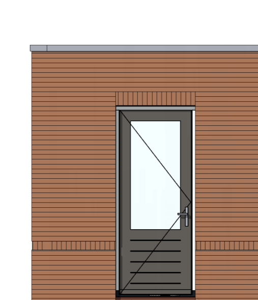
VG5026 - Enkele loopdeur in voorgevel gesponoude berging/aanbouw
